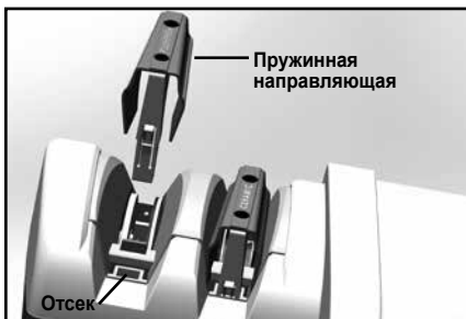
Рисунок 19. Удаление пружинных направляющих из отсека.
